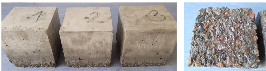
Obr. 6 Zkušební tělesa zkoušená dle metody A po 100 cyklech, vpravo detail porušení
