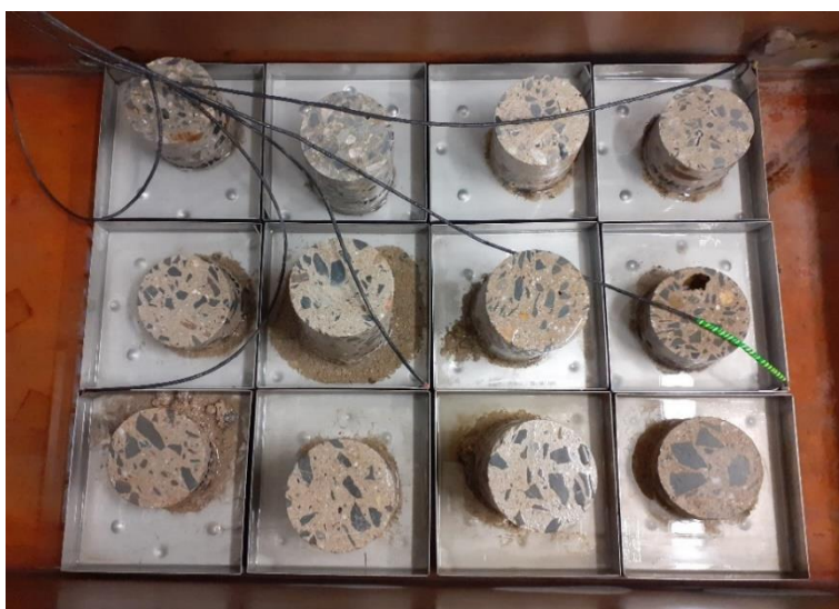
Obr. 4 Zkušební tělesa umístěná v zařízení KD-20 po druhých 25 F-T cyklech
