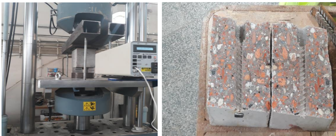
Obr. 3 Zkouška soudržnosti s betonářskou výztuží
