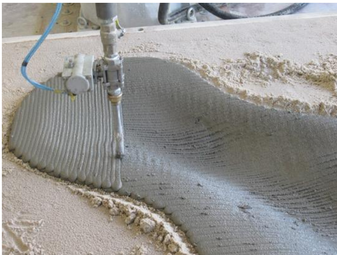
Obr. 4 Postup extruze deskového prvku rezervoáru pod hlavní sochu. Metoda aditivní robotické fabrikace UHPC
