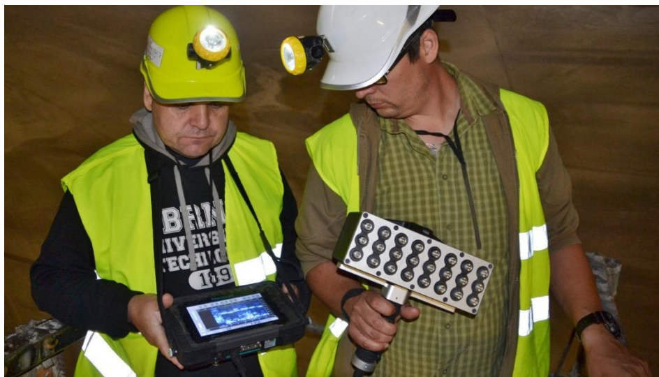
Obr. 2 Ultrazvukový přístroj Pundit 250 Array s maticovou sondou osazenou 24 snímači typu DPC, uspořádanými do 8 řad
