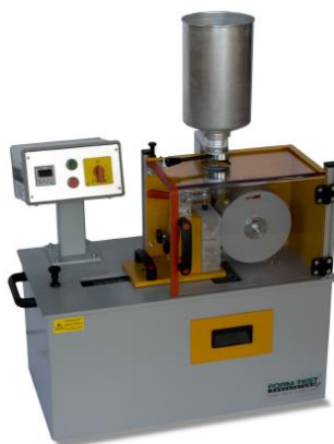
Obr. 2 Zařízení pro stanovení ohrusnosti pomocí širokého brusného kola
