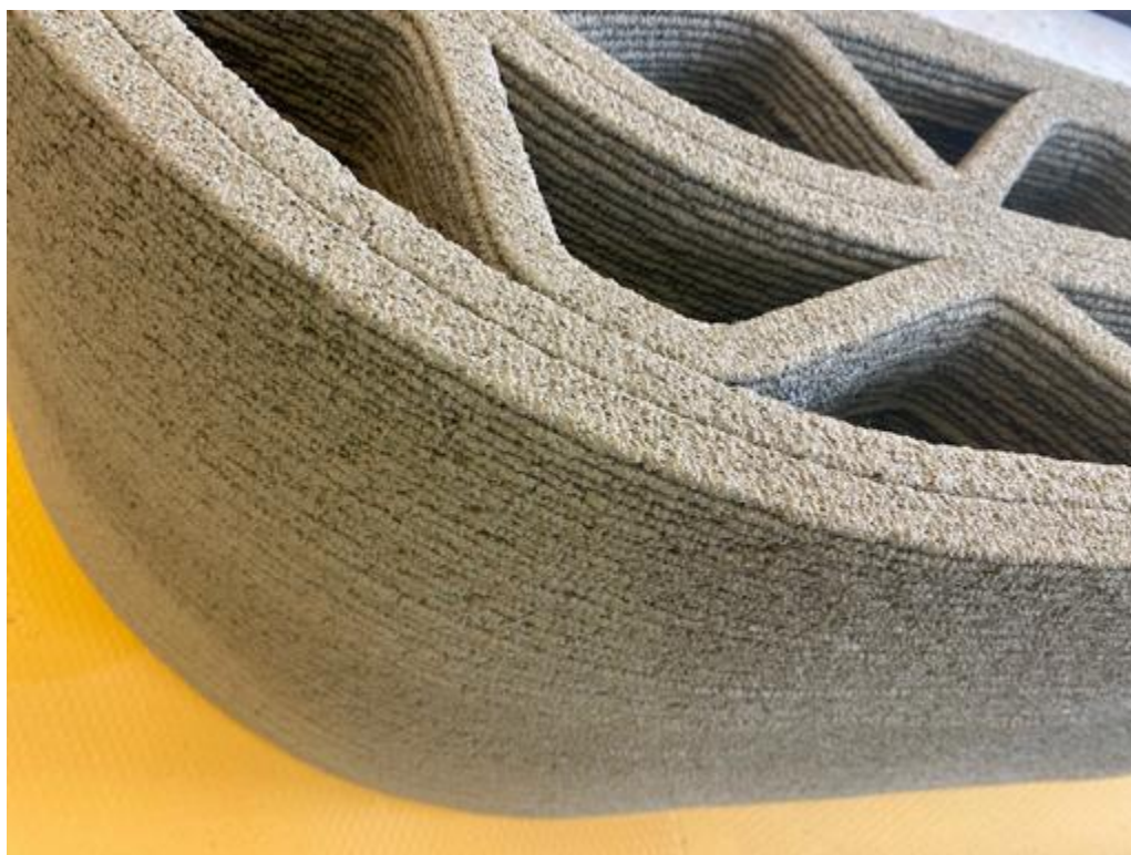
Obr. 7 Extrudovaný vzorek stěny z UHPC
