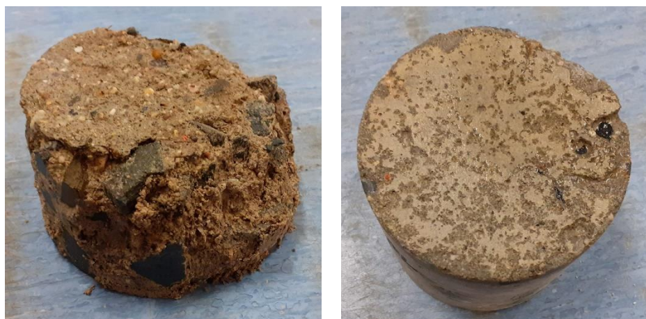
Obr. 5 Zkušební těleso V4 (vlevo) a zkušební těleso V12 (vpravo) po 50 cyklech
