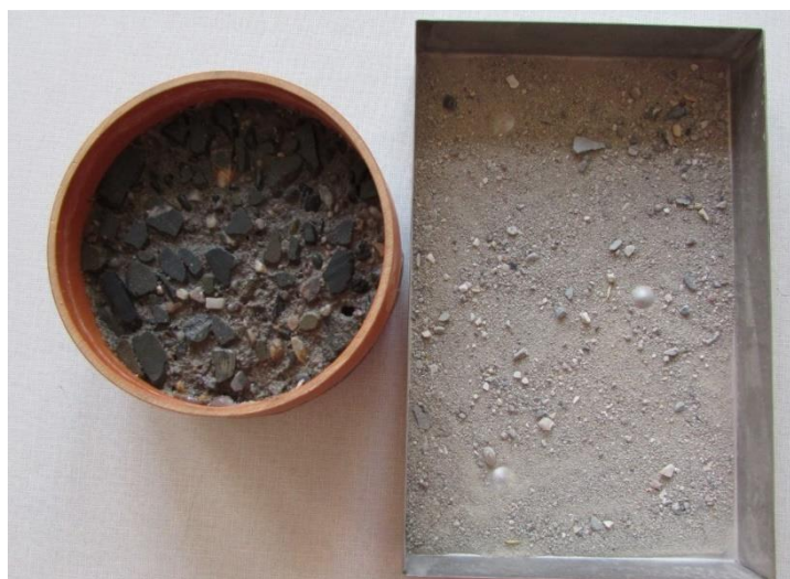
Obr. 2 Zkušební těleso 2 po zkoušce odolnosti proti CHRL včetně odpadu z povrchu tělesa
