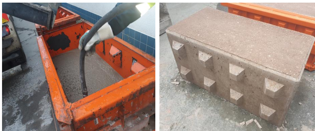
Obr. 2 První výrobky z Rebetongu – prefabrikované stěnové dílce ReBlok
