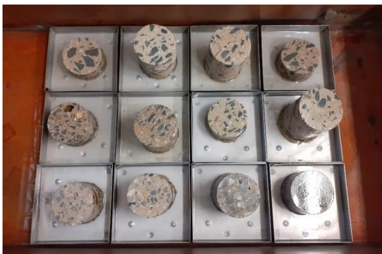
Obr. 3 Zkušební tělesa umístěná v zařízení KD-20 po prvních 25 F-T cyklech
