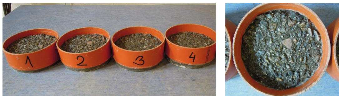
Obr. 7 Zkušební tělesa zkoušená dle metody C po 100 cyklech, vpravo detail porušení
